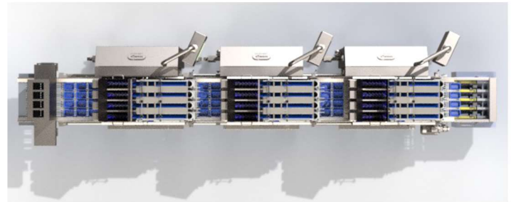
2) LAYOUT : Posición alineada de las pesadoras sobre el transportador / termoformadora.
